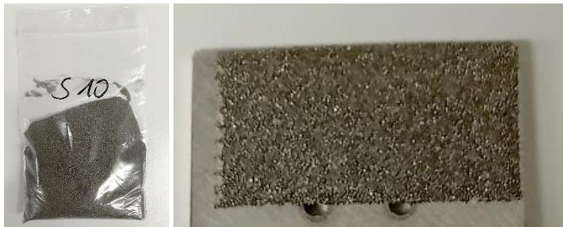
Abbildung 1 Pulverprobe (links) und Aufbereitung als Probe für die Messung (rechts)
